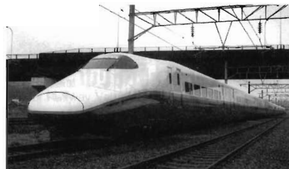
図6 世界初のフルアクティブが装備された E2 系新幹線電車 (JR 東日本)
